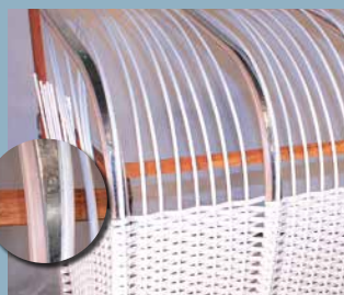
Haubenbügelverstärkung aus verz. Spaltband 25 x 3 mm, gibt dem Oberkorb noch mehr Stabilität
